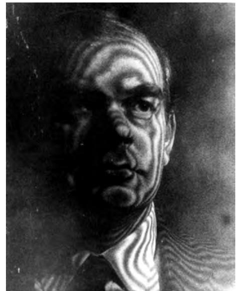
Holografisches Interferogramm eines Porträts. Diese Aufnahme ist als Einzelaufnahme zu verstehen, wobei die zweite Aufnahme durch die Schnelligkeit des Impulslasers entsteht. Das heißt, das Laserlicht trifft unmittelbar hintereinander auf das Objekt.
