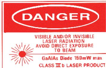
Sämtliche Laser sind in Gefahrenklassen eingeteilt und ein entsprechendes Warnschild muss sich auf dem Laser befinden. Laserklasse 1, 2, 3a, 3b, 4. Nie in den unaufgeweiteten Laserstrahl schauen - eine Netzhaut Verletzung ist die Folge. Gegebenenfalls ist eine Laserschutzbrille zu verwenden und die Sicherheitsvorschriften sind unbedingt einzuhalten.
